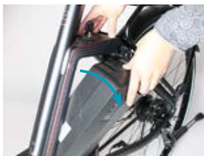
bij 2. Accu verwijderen
