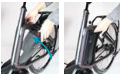
bij 3. Accu in het dockingstation schuiven
