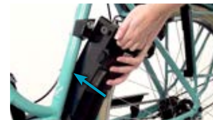
bij 3. Accu in het dockingstation schuiven
