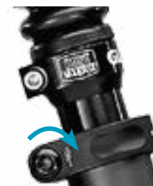
bij 3. Zadelschroef(ven) vastdraaien
