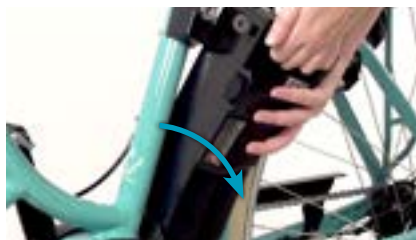
bij 2. Accu verwijderen
