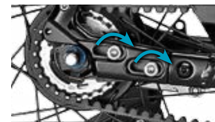
bij 4. Schroeven vastdraaien
