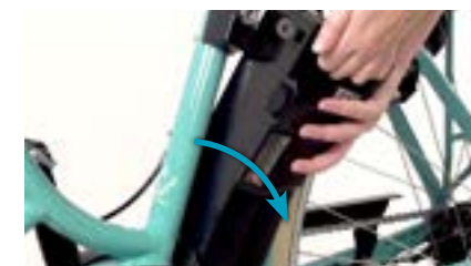
bij 2. Accu verwijderen
