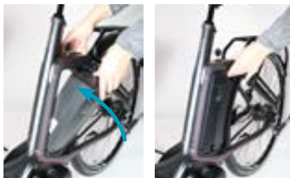
bij 3. Accu in het dockingstation schuiven
