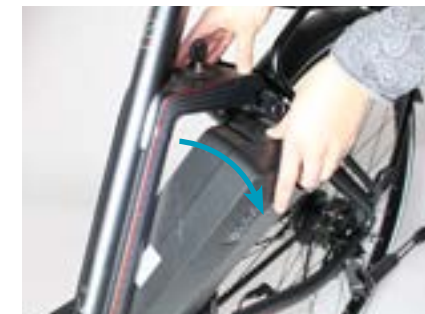
bij 2. Accu verwijderen
