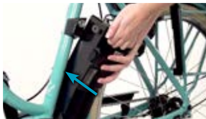
bij 3. Accu in het dockingstation schuiven
