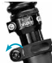
bij 1. Zadelschroef(ven) losmaken
