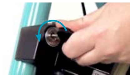
bij 1. Accu ontgrendelen
