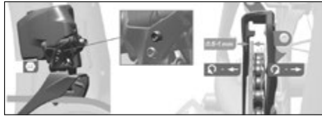
Afb. 96 Bovenste aanslag instellen ©Sram
