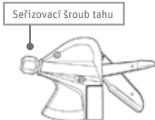
Obr. 61 Změna napětí tahu ©Shimano
