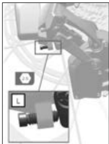
Sl. 94 Vijak prislona L ©Sram
