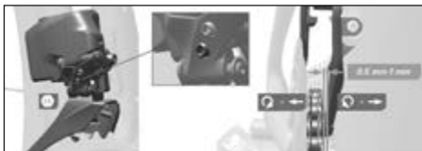
Obr. 97 Nastavenie horného dorazu ©Sram
