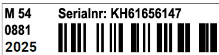
Abb. 11 Rahmen-Aufkleber: Barcode-Label (beispielhaft) mit Rahmengröße (M 54), Rahmenfarbe (0881) Baujahr (2025) und Seriennummer
