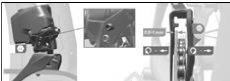
Fig. 96 Regolazione arresto superiore ©Sram
