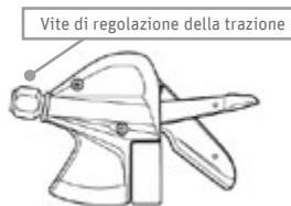
Fig. 83 Modifica della tensione di trazione ©Shimano
