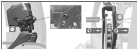
Fig. 96 Ajustar el tope superior ©Sram
