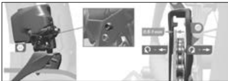
Fig. 96 Justering av øvre anslag ©Sram
