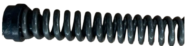
Ilustracja 66 Czarna sprężyna wspornika siodełka (dla rowerzystów o wadze do 110 kg)
