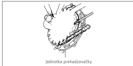
Obr. 129 Tip: odstránenie puzdra kábla ©Shimano
