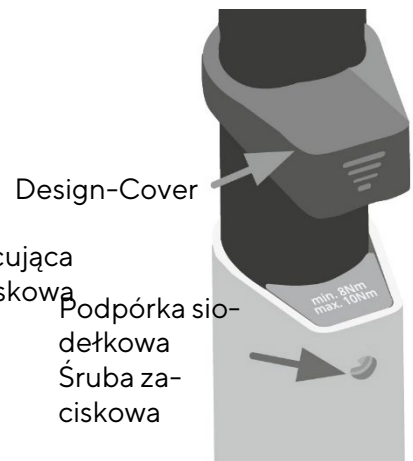
Ilustracja47 Śruba mocująca wspornik siodełka i designerska osłona wariant 3
