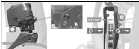
Sl. 96 Nastavitev zgornjega prislona ©Sram
