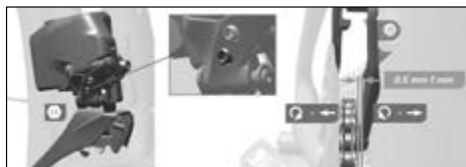
Fig. 97 Reglați opritorul de sus ©Sram
