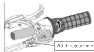
Fig. 101 Passaggio a una marcia inferiore ©Shimano
