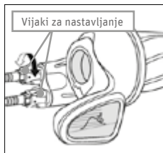
Sl. 105 Obračanje vijakov za nastavljanje ©Shimano
