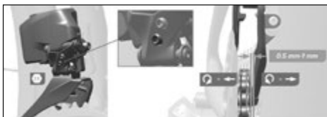
Fig. 97 Ajustar el tope superior ©Sram
