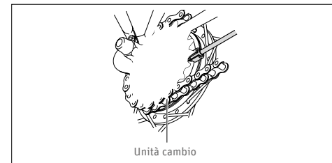
Fig. 129 Consiglio per rimozione guaina dei cavi ©Shimano
