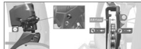
Fig. 96 Réglage de la butée supérieure ©Sram
