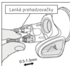
Obr. 106 Jemné potiahnutie laniek prehadzovačky ©Shimano
