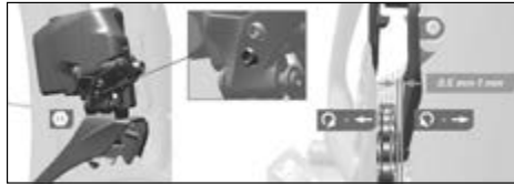
Kuva 97 Ylemmän rajoittimen säätäminen ©Sram
