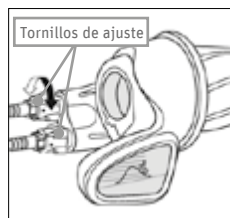
Fig. 105 Girar los tornillos de ajuste ©Shimano
