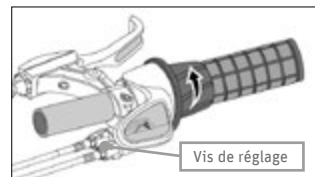
Fig. 101 Passer à une vitesse inférieure ©Shimano
