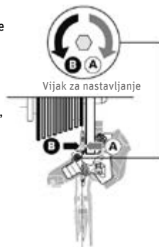
Sl. 82 Obračanje zgornjega vijaka za nastavljanje ©Shimano
