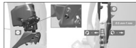
Fig. 97 Réglage de la butée supérieure ©Sram
