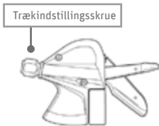
Fig. 61 Juster trækspænding ©Shimano
