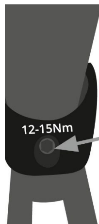
Ilustracja46 Śruba mocująca wspornik siodełka, wariant 2
