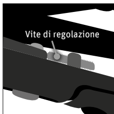
Fig. 110 Rotazione della vite di regolazione
