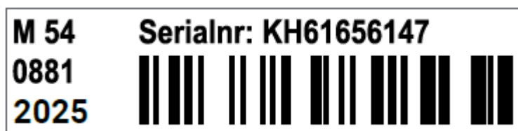
Ilustracja11 Naklejka na ramie: etykieta z kodem kreskowym (przykładowa) z rozmiarem ramy (M 54), kolorem ramy (0881), rokiem produkcji (2025) i numerem seryjnym
