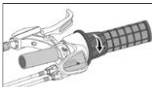
Obr. 102 Přeplnutí na vysoký převod ©Shimano
