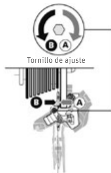
Fig. 82 Girar el tornillo de ajuste superior ©Shimano
