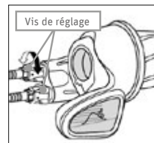
Fig. 105 Ajustage des vis de réglage ©Shimano
