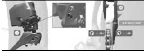
Fig. 97 Justering av øvre anslag ©Sram
