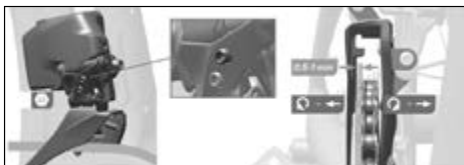
Fig. 96 Indstilling af øverste anslag ©Sram
