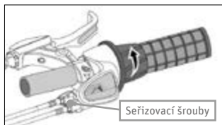
Obr. 101 Přeplnutí na nízký převod ©Shimano
