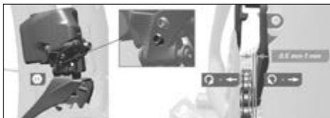
Obr. 97 Nastavení horního dorazu ©Sram
