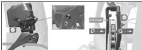
Obr. 96 Nastavení horního dorazu ©Sram
