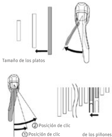
Fig. 72 Cambiar a una marcha más baja ©Shimano
